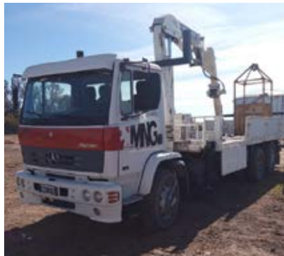
Mercedes Benz 1720 con equipamiento de hidrogua HIDROGRUBERT N10000
