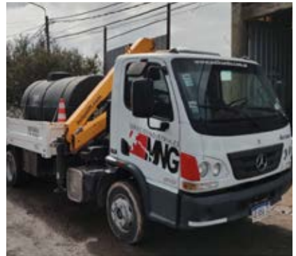
Mercedes Benz ACCELO 815 con equipamiento de hidrogua AXION LIFT AG525 1M y cisterna de 3000 lts
